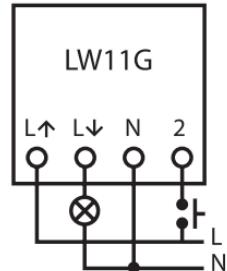
Nun können Sie den Schalter von Hand testen und die Steuerung mit einem Marmitek X-10 Sender.
