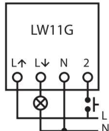
Vous pouvez désormais contrôler votre interrupteur soit manuellement soit en utilisant un contrôleur Marmitek X-10.
